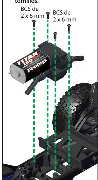
4. Retire el motor con escobillas de la transmisión; instale el motor sin escobillas y la placa de montaje utilizando el hardware incluido.
